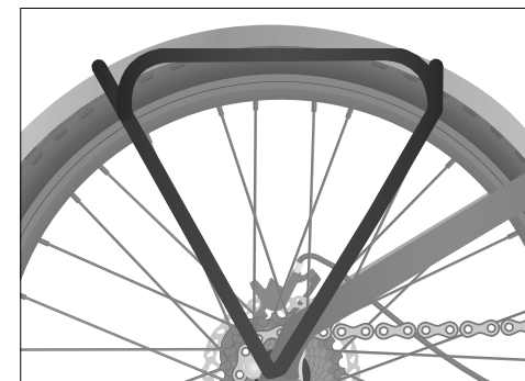
Sl.: Nosilec za prtljago Low-Rider (na podlagi primera)
