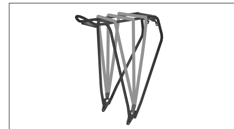
Sl.: Nosilec za prtljago z anepnjalnimi pasovi (na podlagi primera)
